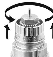
La plage de pré réglage s'étend de 1 à 4 puis N. Avec un réglage N, le robinet est complètement ouvert. Ce réglage peut être utilisé comme position de vidange ou de rinçage. Dans les installations monotubes, le réglage N doit être utilisé.
