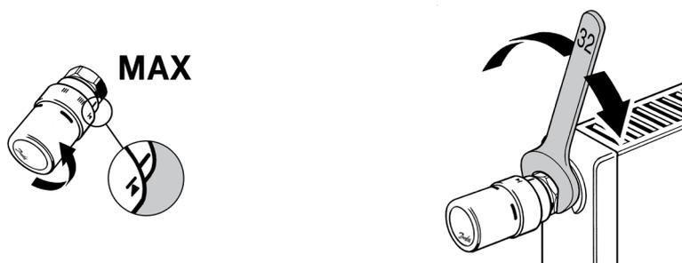
Fixez la tête sur la vanne du radiateur à l'aide d'une clé plate M32.
