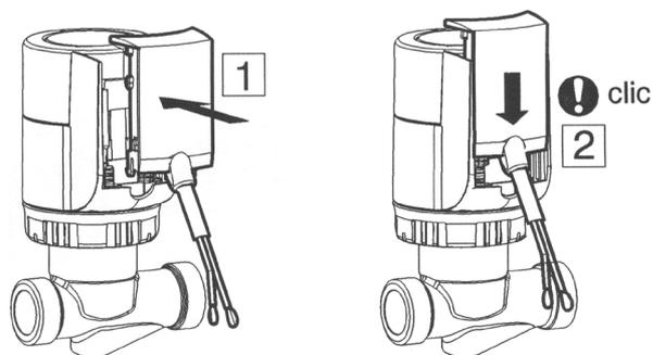
Figure 3 : Mise en place du câble
