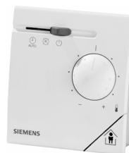
Appareil d'ambiance QAW50, avec sonde d'ambiance et correction de la température ambiante (par bouton de réglage)
